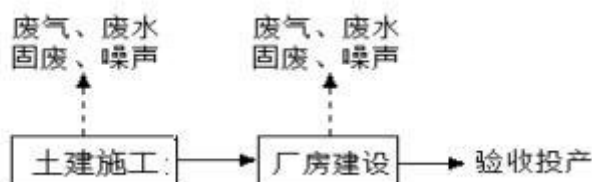
图 2-2 本项目施工建设期流程及排污节点示意图
