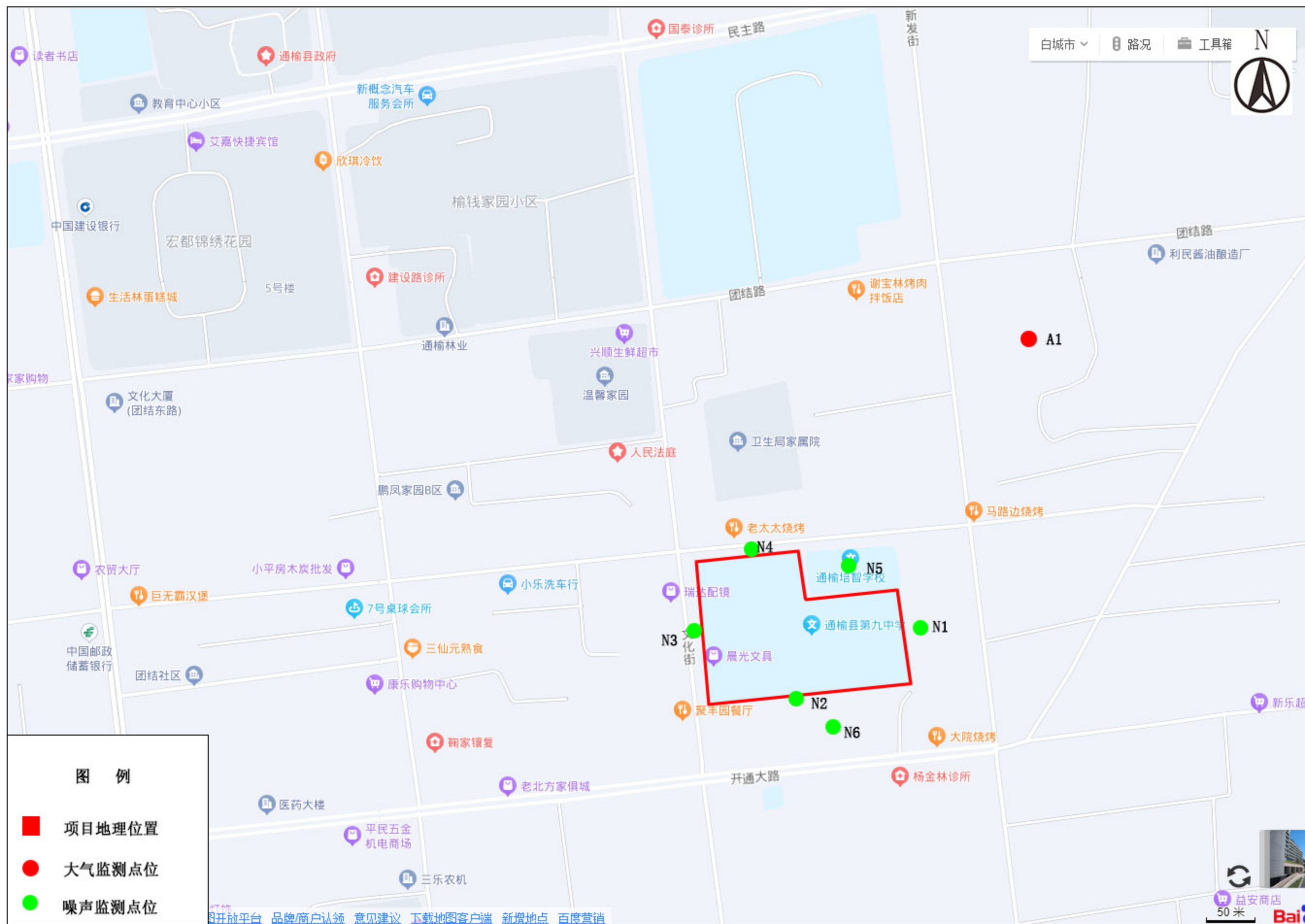
附图7 本项目噪声、大气监测点位布置示意图
